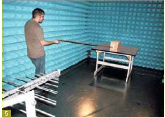
5 BiConiLog Antenne und Hager Funk-Taster WHT390 auf Tisch an Holzklötz befestigt, Taster wird mit Holzstab betätigt, Bedientasten gegen die Messantenne gerichtet.
